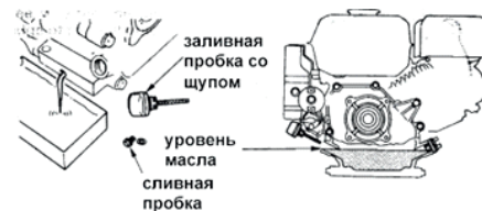
Рисунок 9 - Замена масла в двигателе
