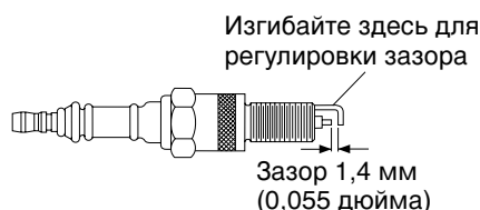
Рис. 12. Регулировка зазора свечи зажигания, нагреватель мощностью 10 кВт
