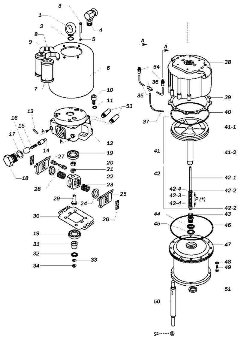
Рис. 9.1.1. Устройство мотора окрасочного аппарата.
