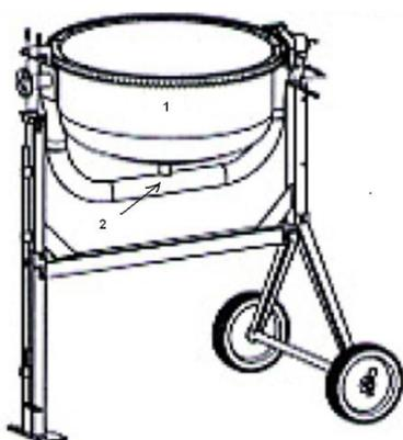
Установите нижний барабан (1) с осью крепления (2) на стойке основания барабана так, чтобы ось вошла в каналы стоек. Ось большого диаметра должна опираться на неподвижную опорную стойку. Зафиксируйте ось в стойках болтами М8 х 70.
