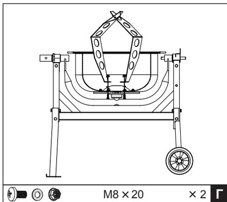
Установите лопасти для перемешивания внутри нижнего барабана свободно, как показано на рисунке. В основании барабана имеются два отверстия, в которые снаружи может быть вставлен винт с крестообразной головкой. Изнутри на него должны быть свободно навинчены кожаная шайба и контр-гайка. Шайба размещается под лопастью вниз напротив барабана.
