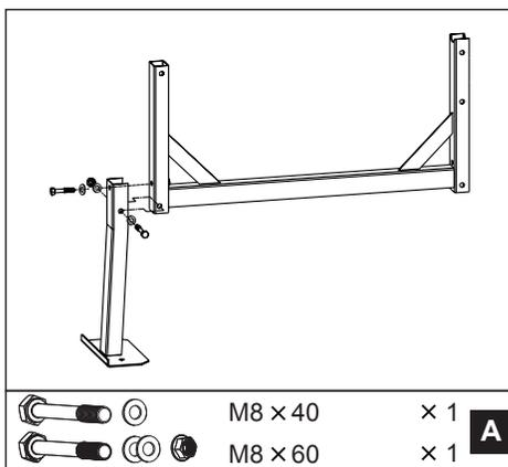
1. Положив раму на бок, прикрепите опоры, как показано на рисунке. Вставьте болт с шестигранной головкой M8X60 в отверстия с одной стороны, затем плоские шайбы и контр-гайку с другой стороны. Затем завинтите болт с шестигранной головкой M8X40 с плоской шайбой в гайку на раме. Затяните.
