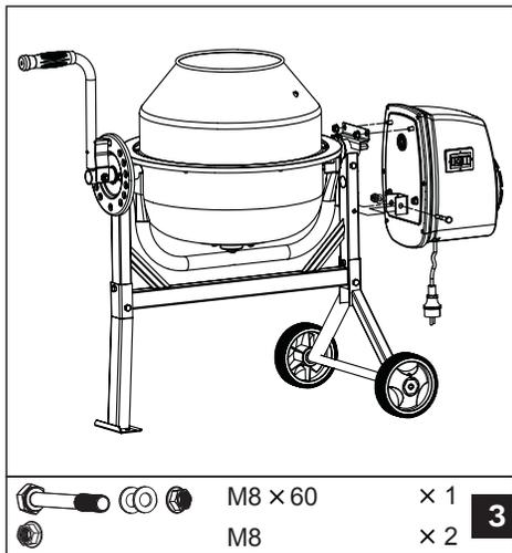
Совместите установочные пазы и установите кожух трансмиссии на вал-шестерню. Закрутите две контр-гайки на резьбовую бобышку кожуха трансмиссии. Закрепите нижний монтажный кронштейн на раме болтом М8Х60, двумя плоскими шайбами и контр-гайкой.
