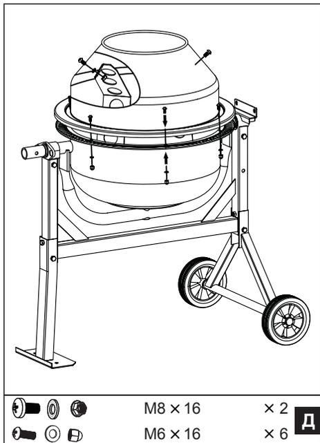
1. Установите верхнюю часть барабана на обод нижнего барабана так, чтобы отверстия в обеих частях и стрелки на них совпадали.
